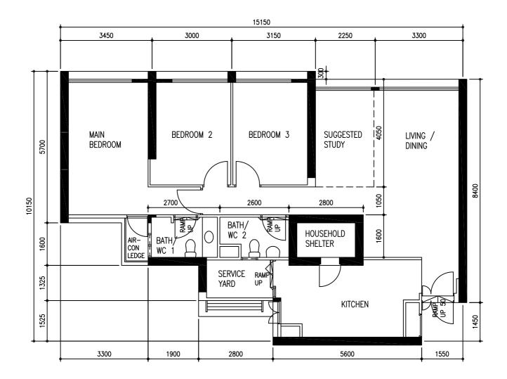
5 ROOM IMPROVED (POINT BLOCK - END) TYPE 2B(H), 2C(H) & 2D(H) SCALE 1:100
